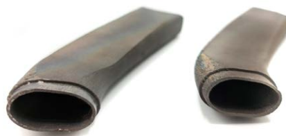
Suporte da corrente de titânio impresso em 3D no sistema RenAM 500S
