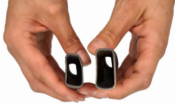
Comparação entre um suporte da corrente soldado à mão e componente de metal impresso em 3D
